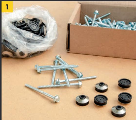
**1** Per applicare le viti, scelte in base al materiale della struttura, si deve **preforare la lastra con una punta avente sezione maggiore di 3 mm rispetto a quella del gambo della vite**; questo per dare tolleranza alla dilatazione della lastra.
